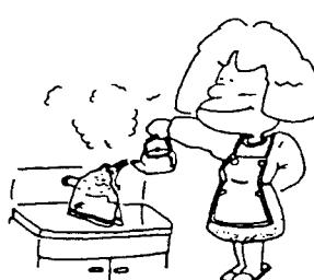
タオルを蛇口にかぶせ、その上からぬるま湯をかけて溶かします。急に熱湯をかけると給水管が破裂したり、蛇口をいためることがありますので注意してください。
