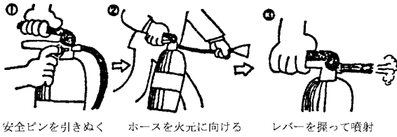
安全ピンを引きぬく ホースを火元に向けて レバーを操って噴射
